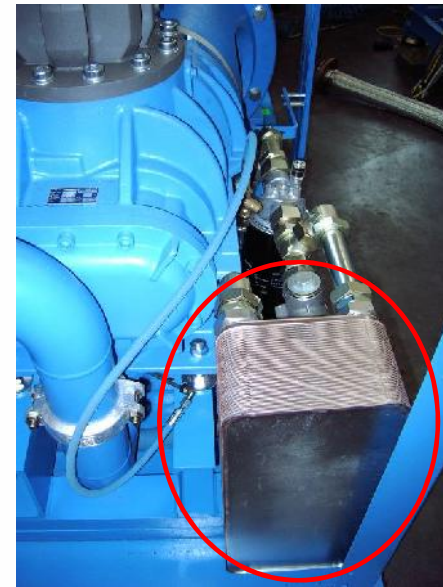
Intercambiador de calor de placa integrado en el compresor
